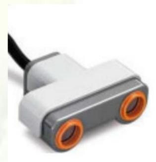
Ультразвуковой датчик – позволяет роботу реагировать на движение и измерять расстояние до объекта (до 255 см с точностью  $\pm 3$  см)
