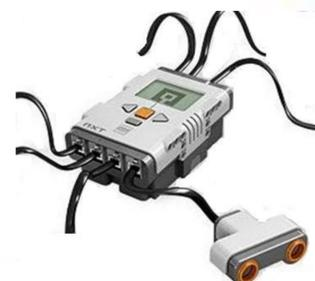
Блок управления NXT – это микрокомпьютер, который управляет работой робота
