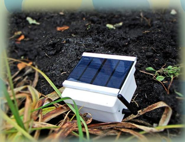
1. Измерения температуры, влажности воздуха и почвы.
