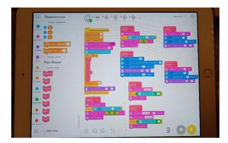
Код программы на графическом языке в среде LEGO Spike Prime
