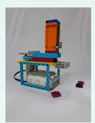
Этот робот соединён с первым роботом по блютуз когда тот робот закончил свою роботу, этот робот выдаёт жетон который может потратить на одну из вещей, или поиграть в игру, или на микро зелень.
