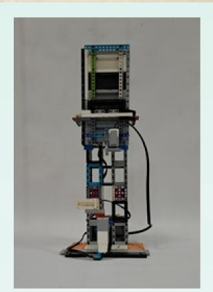
Этот робот самый главный в нашем фондамате, он сортирует пластиковые бутылки и алюминиевые банки с помощью ультра – звукового датчика.
