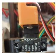
Кроме традиционных для данных роботов датчиков линии и дальномера, используется гироскоп для достижения большей точности движения и определения склонов и лазерный дальномер для поиска пострадавших и зоны эвакуации.
