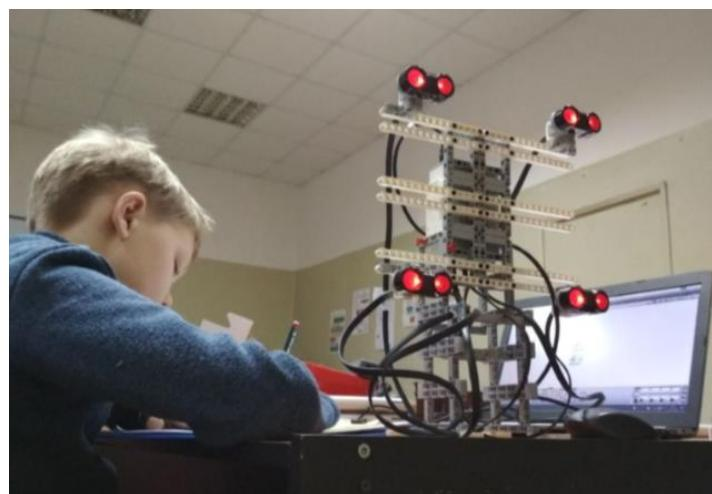
Я провел испытания и после серии экспериментов выявил, что ультразвуковые датчики сканируют пространство до 2,5 метров, а инфракрасные до 1 метра. Но инфракрасные датчики более точные за счет того, что испускаемое ими 4 сигнала разные<sup>6</sup>. Ультразвуковые датчики разных каналов не имеют. Поэтому, чтобы эхо сигналов не пересекались необходимо немного развести их в стороны.
