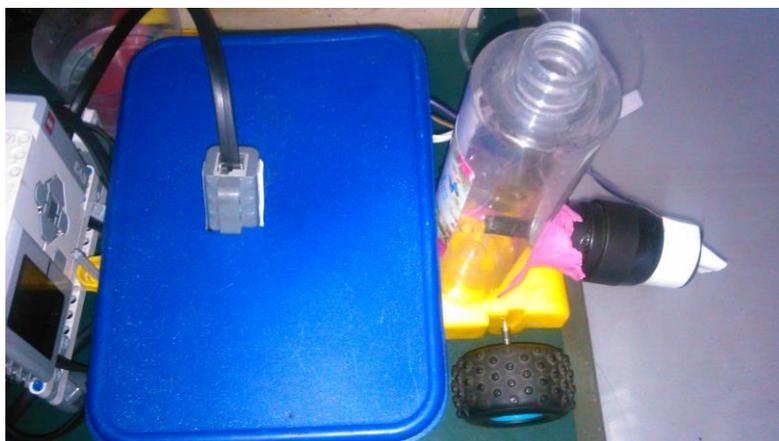
Если при опускании датчика определения влажности загорается не красный светодиод, включается мотор насоса и вода из емкости для полива поступает на обрабатываемый участок. При достижении заданного уровня влажности загорается красный светодиод.
