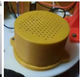
Рисунок 14. Колонка и кольцо - крепление для колонки.
