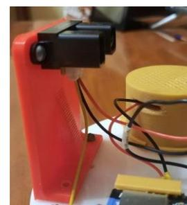
Рисунок 16. Подставка для инфракрасного датчика расстояния
