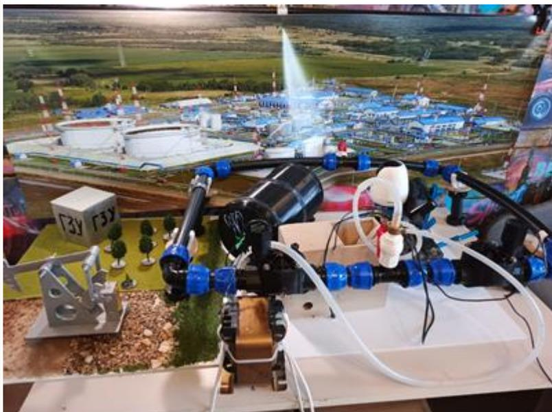
4. 2 электромагнитных клапана (в случае протечки автоматически закрывается нужный клапан, по этой ветке прекращается транспортировка, открывается другой клапан и транспортировка начинается по другой ветке)
