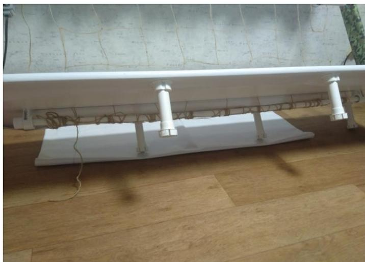
Под платформой установлен барабан (пластиковая труба), на которую накручена сеть. Нижний барабан обеспечивает натяжение сети и её ровное раскручивание в процессе работы робота.
