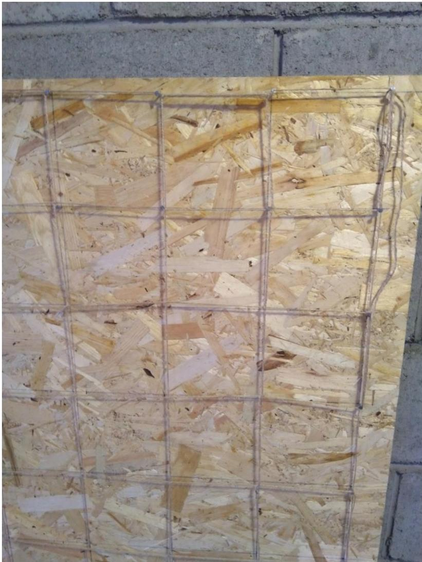
**Для плетения маскировочной сети была создана основа, с размерами ячейки 13x13 см. Данный размер ячейки обеспечивает легкое передвижение робота сквозь них.**
