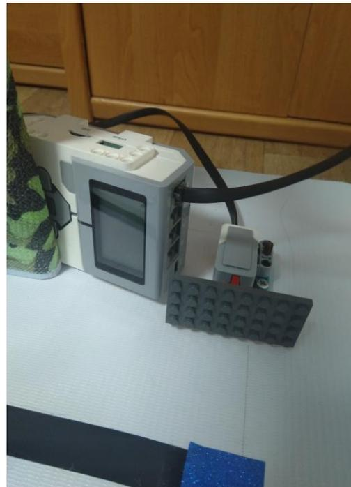
Вращение пластиковой трубы обеспечивает средний мотор робота lego mindstorms ev3, который закреплен к ней через шестерни. Мотор крепится к стойке с помощью балок. Блок lego mindstorms ev3 установлен на платформе. Запуск мотора происходит после нажатия роботом кнопки, установленной в конце маршрута движения робота. Основой кнопки является датчик касания. Для точного попадания робота в кнопку, площадь кнопки была увеличена с помощью пластины из обычного конструктора Lego.
