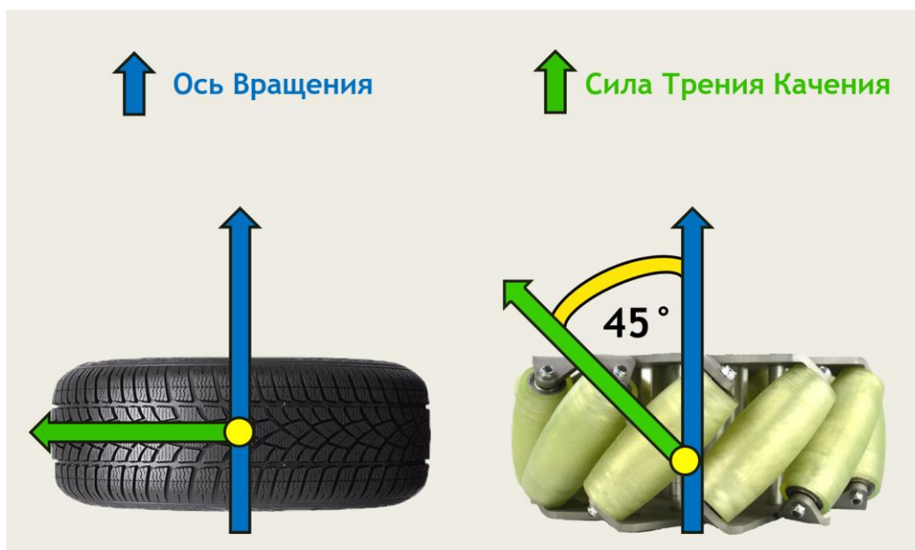
Рисунок 10. – Сравнение силы трения качения, действующей на обычное колесо и колесо Илона при вращении
