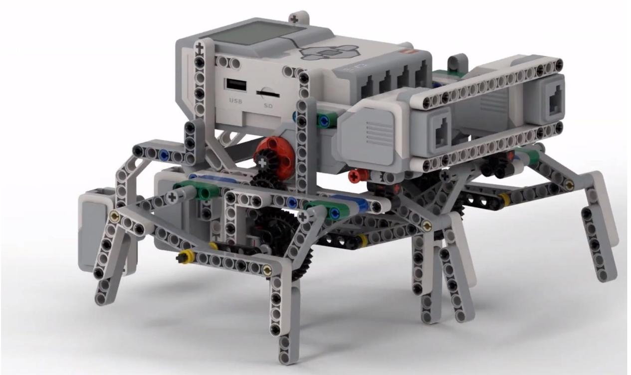
Шагающий робот, сконструированный на основе набора LEGO® MINDSTORMS® EV3. Робот оснащен двумя большими моторами, которые, используются для управления движением ног, что предполагает их способность к сложным, координированным движениям.
