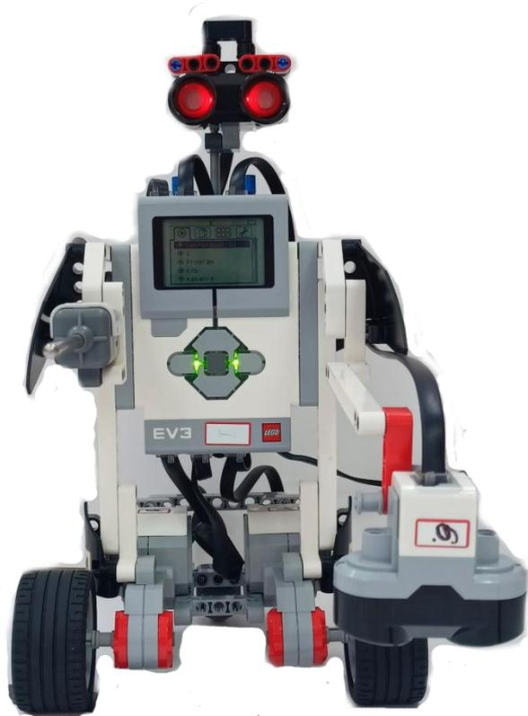
Данная модель робота имеет компактные размеры, высота 30 см, ширина и длина 20 см. Робот работает автономно, зарядки аккумулятора хватает на рабочий день сотрудника.
