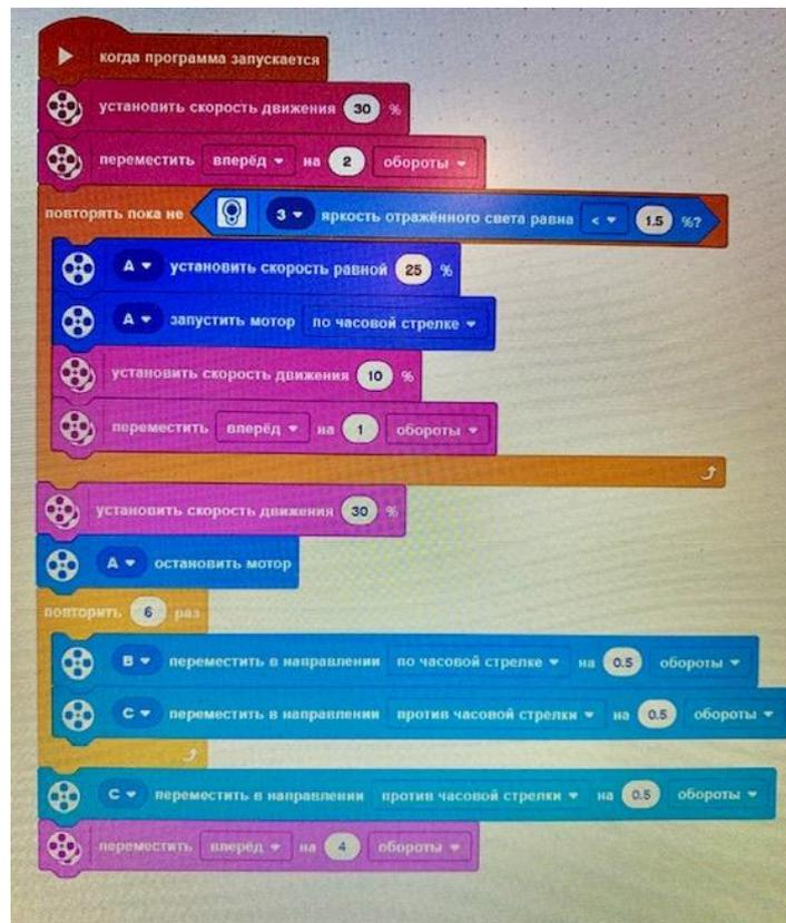
Схема 1. Программа работы робота-бурильщика.
