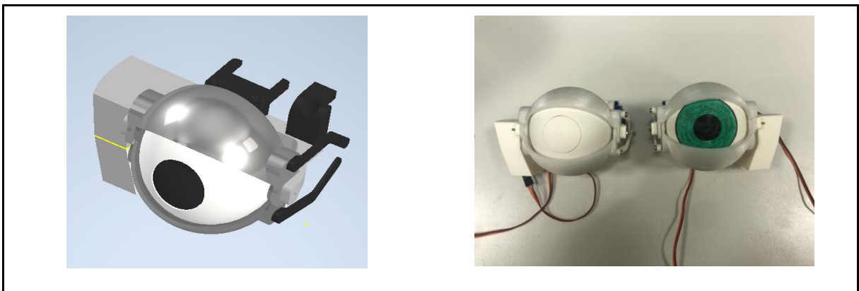
Рисунок 6. Сборка глаза (в Autodesk Inventor) и 3D-печатные детали глаз в сборе.
