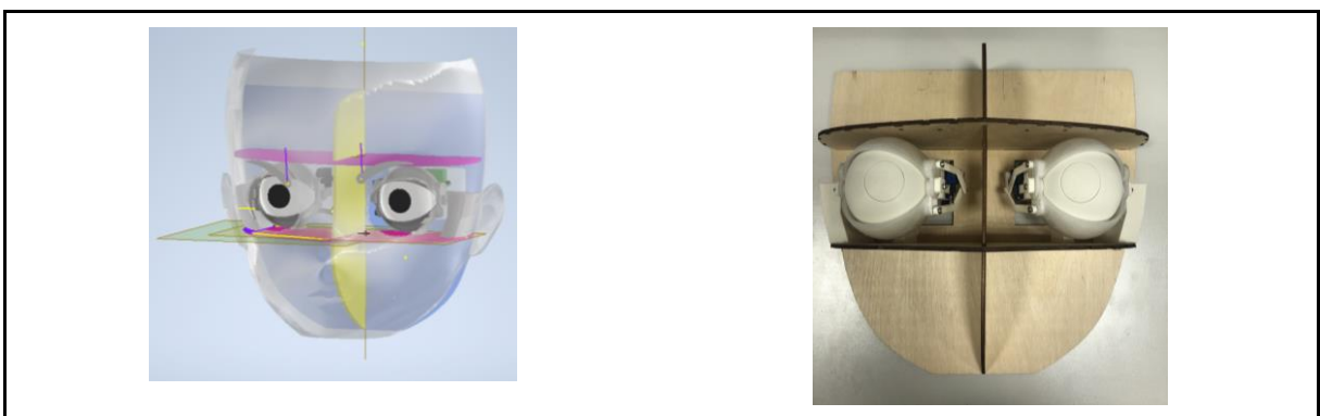
Рисунок 7. Сборка головы (в Autodesk Inventor) и детали каркаса и глаз в сборе (первая версия)
