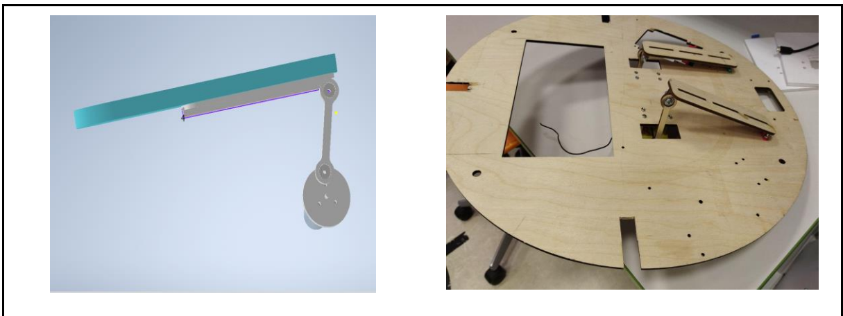
Рисунок 4. Сборка механизма поднятия ботинка (в Autodesk Inventor) и фанерные детали верхней платформы в сборе.
