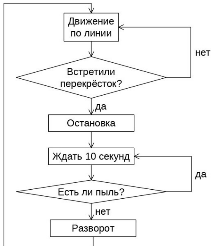
Рисунок 9. Алгоритм автономной работы мобильного очистителя воздуха.
