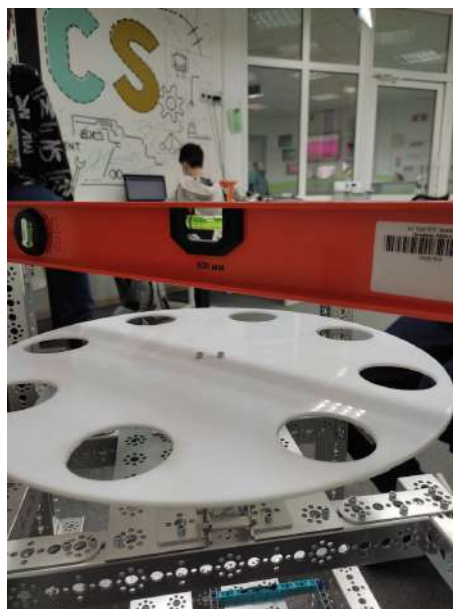
Барабан для выдачи лекарств и установка барабана на робота
