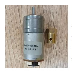
Робот передвигается благодаря двум моторам JGA25-371. Мы выбрали именно эти моторы из-за оптимальной мощности и скорости вращения при своих достаточно компактных размерах.
