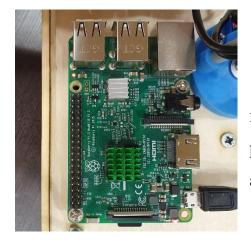
Самым главным элементом в нашем проекте является плата RaspberryPi 3. На роботе их 2: одна отвечает за движение робота, а другая за распознавание букв.
