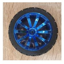
Мы думали над диаметром колёс и остановились на колесах диаметром 67мм, так как имеем большой опыт построения роботов с ними, а также они как нельзя кстати подходят к используемым нами моторам.
