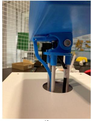
Вся конструкция выполнена из дерева и пластика. Поворотная ось головы выполнена в виде шеи, она держится на трёх алюминиевых трубках, которые расположены по углам вписанного в окружность (пластиковый цилиндр) равностороннего треугольника.
