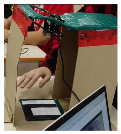
успел на скорую руку построить конструкцию из картона, на вершине которой находилась камера, смотрящая вниз, прямо на карточку с буквой.
