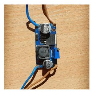
Для распределения напряжения в конструкции использованы 2 преобразователя. Они подключены к батарее напрямую (не считаю кнопку). Один из преобразователей преобразует 15В в 12В для питания обеих плат Raspberry, Arduino и драйвера. Другой преобразует 15В в 5В для питания сервомоторов.
