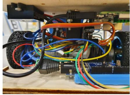
элементов в максимально компактном корпусе. Хотя эту проблему мы и решили, из компактности вытекла другая проблема: Все элементы и порты плат и другой электроники были очень труднодоступными, поэтому на проверку подключения уходило много времени. Из всего вышеперечисленного вытекает уже иная проблема: тяжело разобраться и держать в голове все провода и порты и манипулировать ими. Конкретно в построении особо глобальных проблем у нас не возникало.
