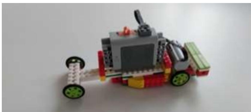
3.1.1. Робот должен быть собран только из деталей наборов 9580 и/или 9585. Конструкция робота должна содержать батарейный блок Лего (59510с01 , 8881-1, 59510, и аналогичные) для запуска движения. В случае отсутствия оригинальных деталей допускается их замена на
