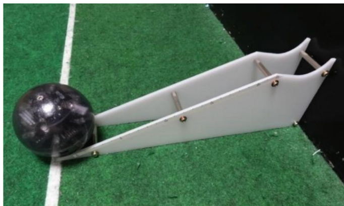
Рис.1. Устройство для определения мощности удара робота
