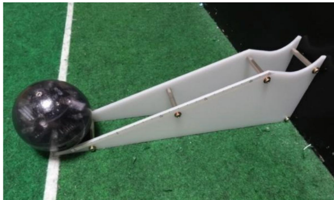
Рис.1. Устройство для определения мощности удара робота
