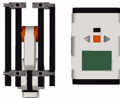
Рис. 5. NXT крепится к угловым балкам
