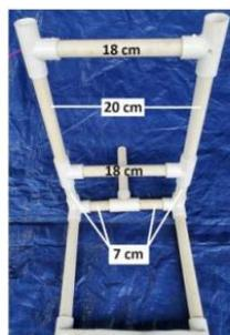
Платформа док-станции - квадрат из трубок ппр 20 длиной 18 см и четырёх тройников. Сверху закреплен прямоугольник из листового материала (например, гофрированный пластик, фомакс и т.д.) Платформа утяжелена.
