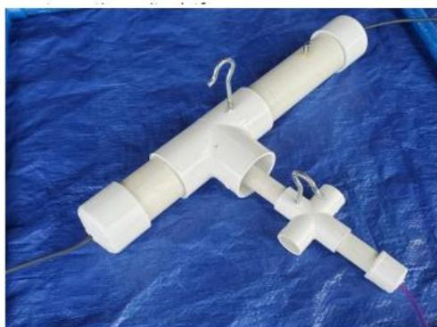
Изготовлен из трубки ппр 20, тройника и заглушки. Для удобства захвата в тройник установлен крюк. К заглушке прикреплена веревка длиной 4 м (длина может быть сокращена). Другой конец веревки привязан к док-станции. На конце разъема закреплена лента Велкро (крючки). Разъем утяжелен и вначале расположен на платформе док-станции.
