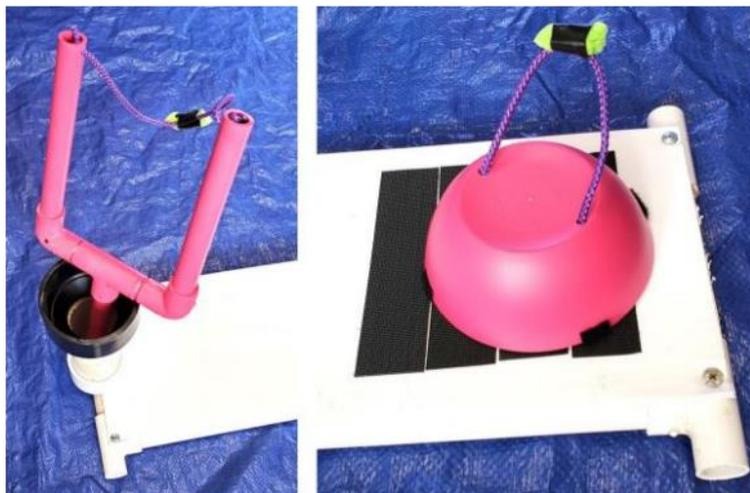
Порт для коралла изготовлен из трубки ппр50 и переходной муфты (может быть заменено на трубку большего диаметра)
