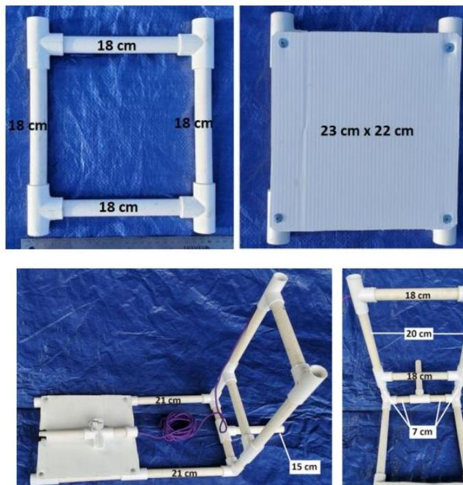
Платформа док-станции - квадрат из трубок ппр 20 длиной 18 см и четырёх тройников. Сверху закреплен прямоугольник из листового материала (например, гофрированный пластик, фомакс и т.д.) Платформа утяжелена.
