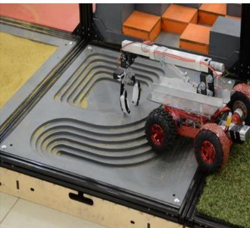
Конструкция состоит из нескольких слоев фанеры, уложенных параллельно друг на друга, которые формируют два углубления. Глубина первого - 70 мм, глубина второго 50 - 60 мм.
