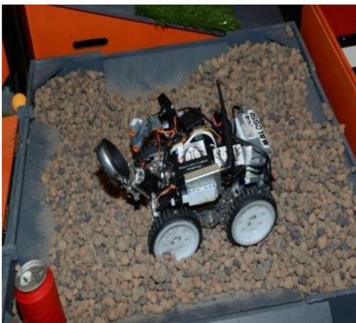
Короб глубиной 40 мм, наполненный керамзитом. Высота керамзитного слоя колеблется в пределах 20-30 мм.
