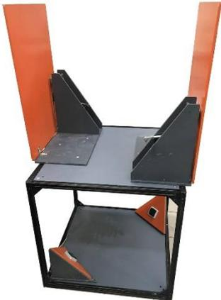
На верхней грани куба размещены два пролета мостов, находящихся изначально в поднятом состоянии. Внутри куба на его нижней грани размещены две кнопки для активации (опускания) мостов. Их последовательное нажатие приводит к одновременному опусканию пролетов мостов. Проездом по мосту считается проезд по верхней грани куба с мостами.
