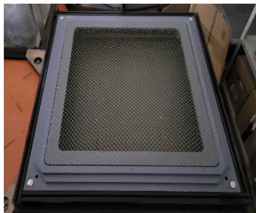
Рамка, на которую натянута сетка. Размер ячейки в сетке – 10x10 мм.
