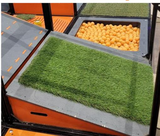
Плоская площадка, установленная под углом 15 градусов, на которой закреплена полоса искусственной травы. Высота ворса — 40 мм. Ширина искусственной травы может варьироваться.
