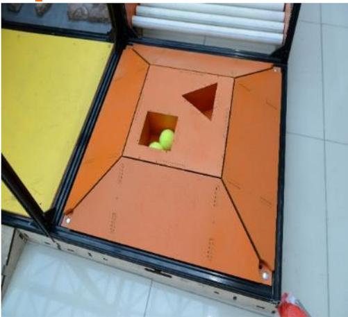
Препятствие включает в себя основание, выполнено в виде усечённой пирамиды с призматическими выемками в верхней части, внутри которых расположены теннисные мячи или обломки. Глубина выемок – 110 мм. Угол наклона скатов испытания - 30°. За захват и доставку каждого обломка баллы начисляются отдельно.
