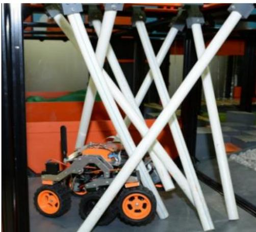
Куб, верхняя грань которого представляет собой площадку с закрепленными на ней разнонаправленными полипропиленовыми трубами. Трубы опираются на нижнюю грань (площадку) куба. Таким образом трубы преграждают путь через куб.
