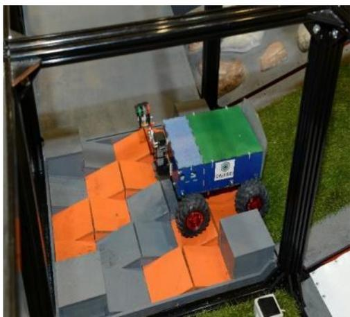
Ячейка заполнена 25-ю закрытыми коробами (рампами). Верхняя грань каждого короба имеет наклон в  $15^\circ$ . Рампы составлены таким образом, что их верхние поверхности образуют по высоте волнообразную структуру.
