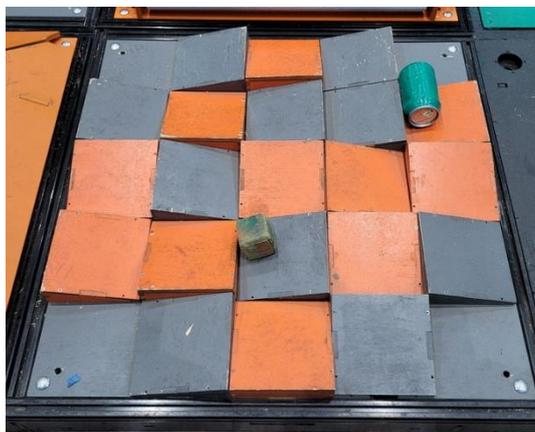
Ячейка заполнена 25-ю закрытыми коробами (рампами). Верхняя грань каждого короба имеет наклон в  $15^\circ$ . Рампы составлены таким образом, что их верхние поверхности образуют по высоте неравномерную структуру. Рампы разной высоты с перепадом высот 50 мм.
