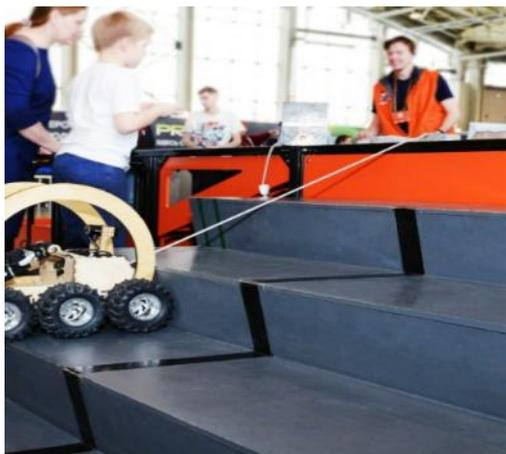
Лестница с габаритными размерами 1480x1220x620 мм, высота ступени 150 мм. Подступенок (вертикальная часть ступени) имеет небольшой обратный наклон.
