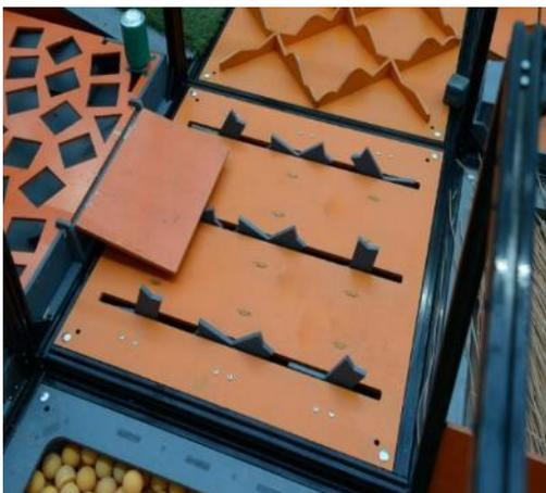
Плоское основание с параллельными прорезями. Внутри прорезей вращаются трёхлучевые звёзды, закрепленные на стержнях, расположенных на тыльной стороне основания. Звёзды выдаются над поверхностью максимум на 70 мм.
