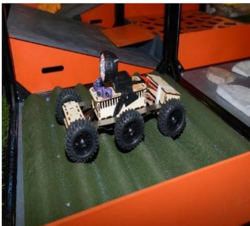
Отрезок волнистого кровельного материала (ондулина). Высота волны 38 мм, период волны 95 мм.
