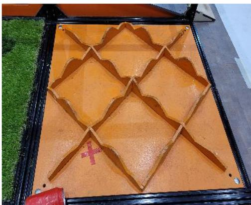
Плоская площадка с прикрепленными перпендикулярно к ней фанерными планками с волнообразной кромкой. Высота планок может колебаться от 10 до 80 мм.
