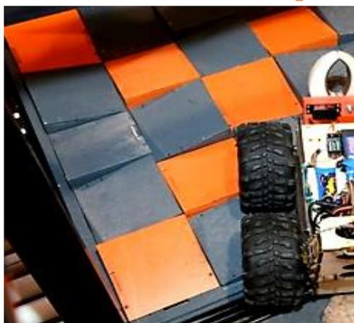
Наклонная 15°, с габаритными размерами 740x690x200 мм, заполненная коробами с углом наклона верхней грани 15°, разной направленности.
