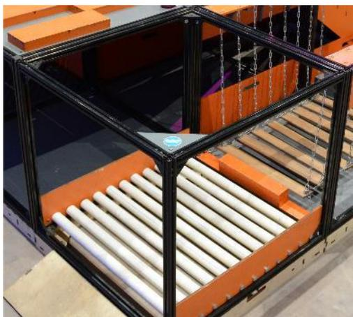
Пол ячейки представляет собой роликовый конвейер из вращающихся вдоль продольной оси полипропиленовых труб.
