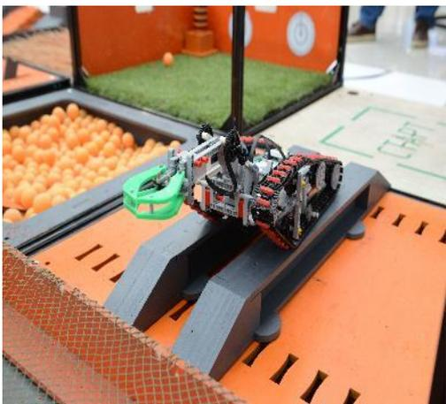
В площадке ячейки проделаны ряды отверстий, в которые вставляются штифты коробов, имитирующих рельсы. Ширина постановки рельс перед стартом регулируется под ширину базы робота, стартующего с ближайшего старта.
