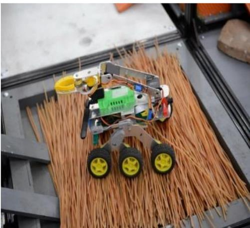
Короб глубиной 40 мм, заполненный проводами. Глубина слоя 20-30 мм.
