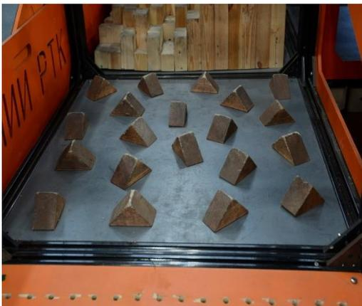
Плоская площадка, на которой закреплены деревянные призмы. Высота шипа – 40 мм, длина грани – 50 мм, ширина шипа – 40 мм.
