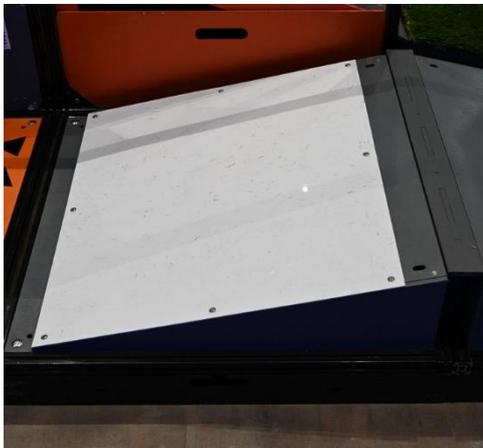
Плоская площадка, установленная под углом 15 градусов, на которой закреплена пластина из полистирола, имитирующая лед.
