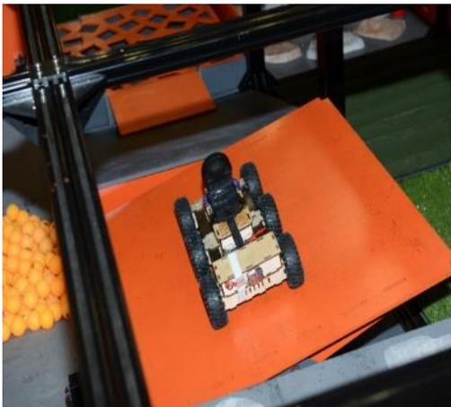
Плоская площадка, качающаяся на продольной оси, проходящей посередине ячейки. Максимальный угол наклона качели составляет около 30°.
