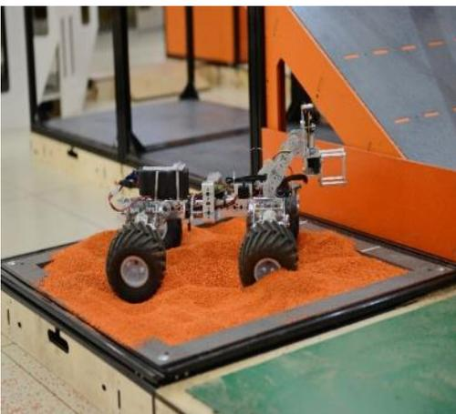
Короб глубиной 40 мм, наполненный песком. Высота слоя песка колеблется в пределах 20-30 мм.
