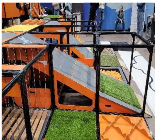
Плоская площадка, установленная под углом 20°. Состоит из 2х ячеек. Въездом на нее служит стандартная наклонная 15°.
