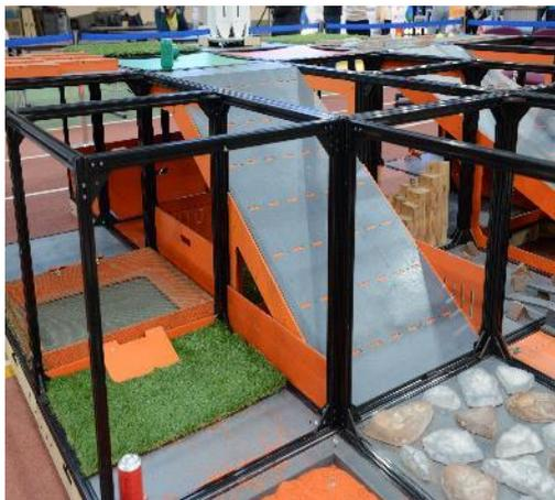
Плоская площадка, установленная под углом 30°. Состоит из 2х ячеек.
