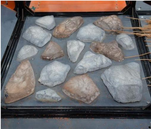
Плоская площадка на которой закреплены камни с острыми углами и резкими перепадами по высоте от 0 до 60 мм.
