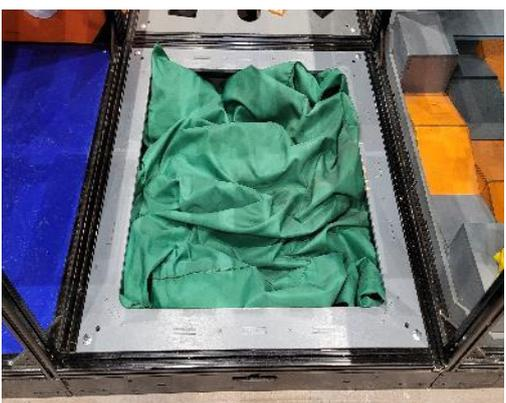
В ячейку уложен полиэстеровый мешок, наполненный до половины полистироловыми шариками фракцией 4-6 мм.
