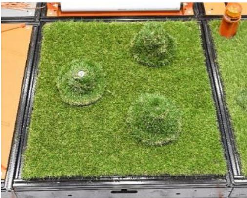
Площадка, покрытая искусственной травой из полипропилена с высотой ворса 18 мм. На ней произвольным образом расположены наборные конструкции из искусственной травы, имитирующие деревья. Максимальный диаметр «деревя» 150 мм, максимальная высота «деревя» 110 мм.
