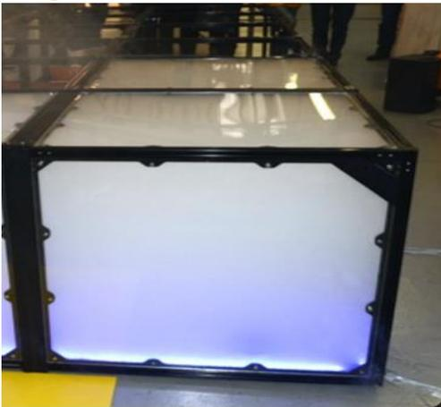
2-3 куба с сильным задымлением, создаваемым дыммашиной. Стенки куба выполнены из прозрачного оргстекла. К полу кубов в произвольном порядке прикручены шипы и светильники из оргстекла, которые можно включить роботом при помощи кнопки, расположенной на полигоне. Секции имеют въезды - арочные проемы 500x500, занавешенные полосками резины.
