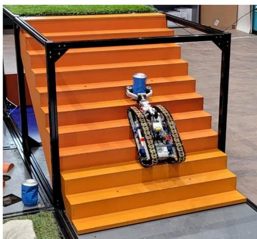
Куб, внутри которого расположена лестница с высотой ступеней 75 мм и длиной 90 мм. Лестница включает в себя прикручиваемый заезд, вместе с которым состоит из одиннадцати равных прямоугольных ступеней.
