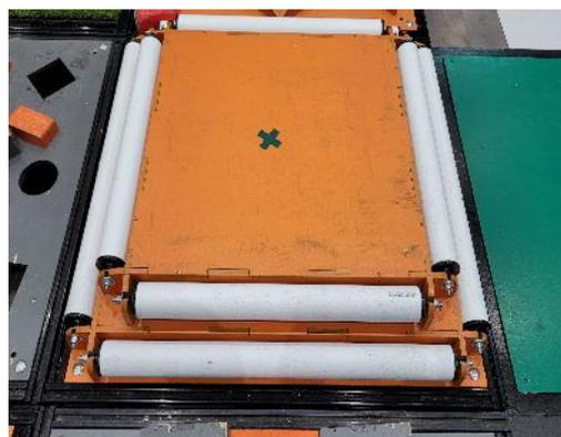
Ступенчатая пирамида, состоящая из двух уровней. Параллельно длинным ребрам каждого уровня закреплены вращающиеся трубы. Общая высота – до 140 мм. Высота ступени - 60 мм.
