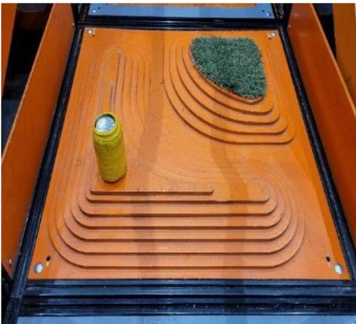
Конструкция состоит из нескольких слоев фанеры, уложенных параллельно друг на друга, которые формируют два возвышения. Высота первого возвышения (выступа) – 70 мм. Высота второго возвышения 50-60 мм.
