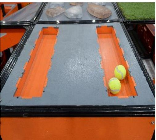
Плоская площадка с двумя параллельными углублениями в форме параллелепипеда (траншеями) глубиной 40 мм. Длина траншеи составляет 670 мм, ширина – 140 мм. Одна траншея заполнена теннисными мячами (65 мм), вторая пустая. Задание: Доставить мяч из одной траншеи в другую. За каждый доставленный мяч начисляются баллы.
