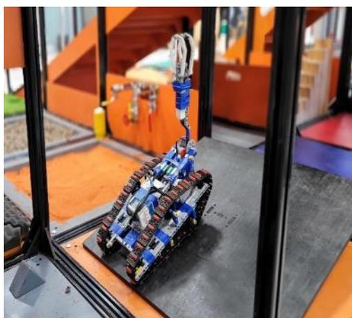
На плоском основании установлена другая плоская площадка с меньшими габаритами, закрепленная при помощи крестовины, обеспечивающей ее наклон в разные стороны. Максимальный угол наклона весов составляет около 30°. Высота в центре - 90 мм, сторона квадратной платформы - 640 мм.
