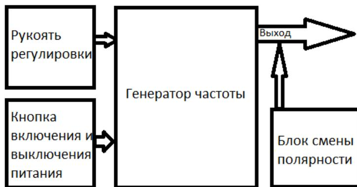
Предлагается спроектировать некоторые части устройства, схема которого представлена на рисунке. Устройство имеет интерфейс, состоящий из двух кнопок, вращающейся рукояти (потенциометра) и трех светодиодов (двух синих и красного), а также трех разъемов. Одна кнопка служит для включения и выключения
